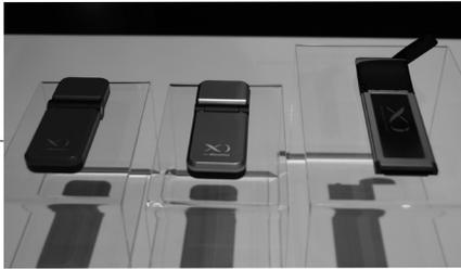
写真1 NTTドコモのLTE対応データ端末〔左側2機種（赤とシルバー）「L-02C」：LGエレクトロニクス製USB型、「F-06C」：富士通製 ExpressCard型（右側、2011年4月発売予定）〕の外観
