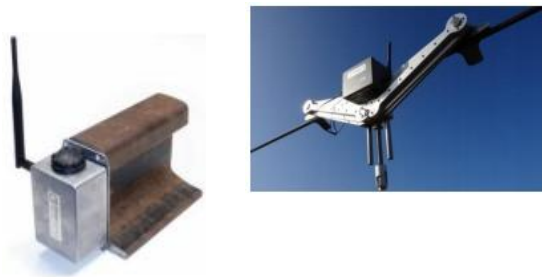
線路温度、ケーブル張力
